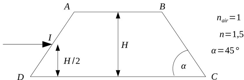
1) Tracer le prolongement du rayon arrivant en  $I$ . Déterminer une condition liant  $DC$  et  $H$  pour que le rayon ressorte à la même hauteur qu'en entrée.
