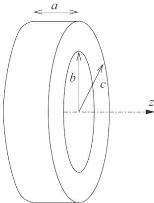
On applique une tension électrique  $U = V(r=b) - V(r=c)$  entre les faces cylindriques interne et externe du conducteur.
